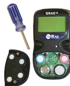
Facilità di accesso al vano sensori
